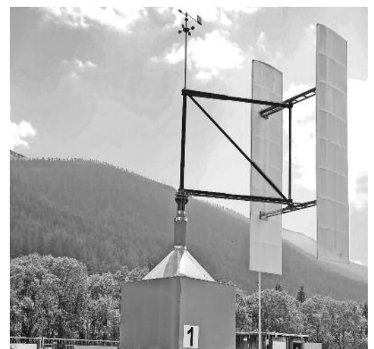
Neuer Zugang. Windkraftgenerator mit transrotorischer Bewegung der Flügel, Kroatien.
